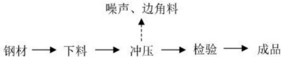
图 2-6 五金制品加工工艺流程产排污环节图
