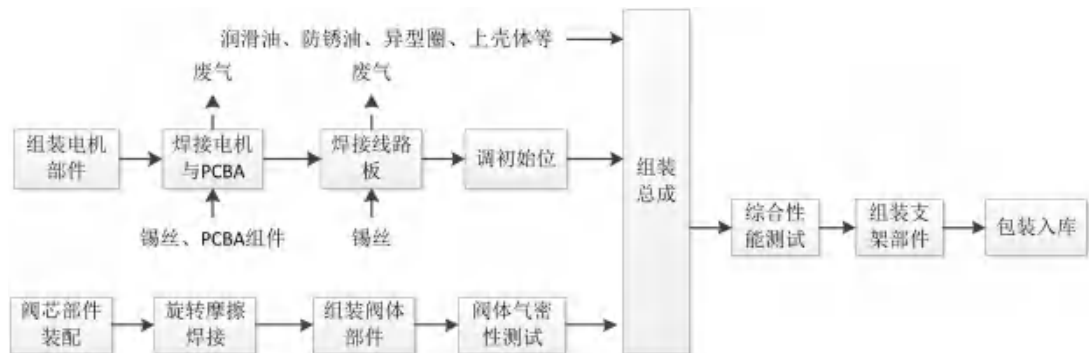
图 2-4 电子水阀生产工艺及产污环节流程
