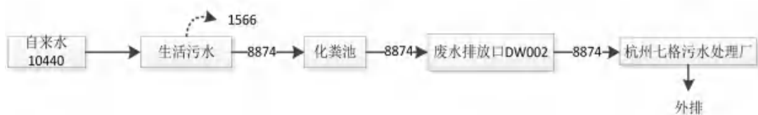
图 2-1 本项目水平衡图 单位 t/a
